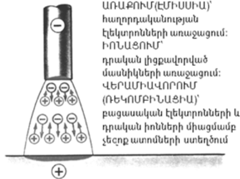
Ուղիղ բևեռականությամբ աղեղի գոյացման գործոյթներ.
