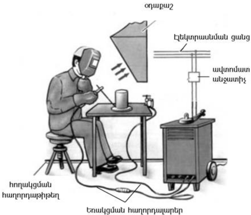
Եռակցման տրանսֆորմատորով սարքավորված աշխատատեղ
